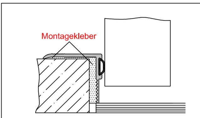
3. Montagekleber innenseitig auf waagrechten und senkrechten Schenkel auftragen. Eine sofortige Haftung und Begehbarkeit wird erreicht, wenn zusätzlich punktweise Heißkleber aufgetragen wird.
