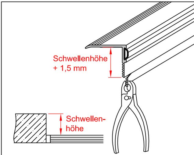
2. Schwellenhöhe messen und perforierten senkrechten Schenkel mit Flachzange auf Schwellenhöhe abdrehen.
